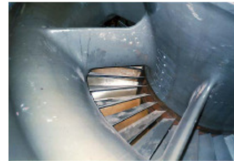
Voluta di aspirazione con razze di supporto e centraggio della cassa del cuscinetto N° 1. Palette di entrata ad assetto variabile (IGV)
